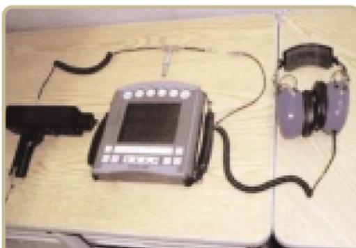
*Figure 7 : Ultraprobe mis en complément avec un collecteur-analyseur FFT de vibration Entek-IRD Datapack servant à l'expertise des réducteurs et paliers inaccessibles sur des lignes d'arbres.*
