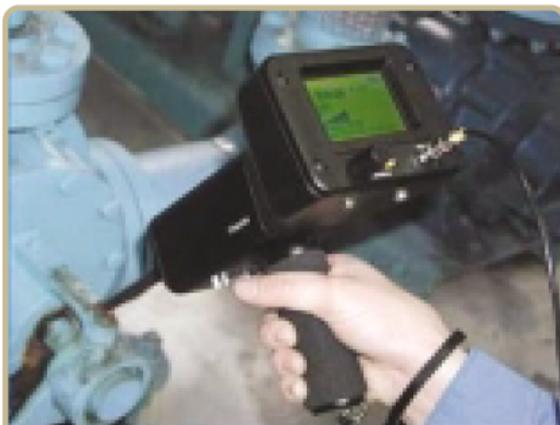
*Figure 6 : le détecteur de défauts US Ultraprobe 10 000 peut enregistrer les niveaux relatifs en décibels ; les fréquences centrales d'écoute et leurs signaux audio-temporels sont enregistrés pour une analyse spectrale via un logiciel de post-traitement. Ces fonctionnalités sont très utiles pour le suivi qualitatif des roulements et engrènements tournant jusqu'à de très basses vitesses (jusqu'à 10 tr/min).*
