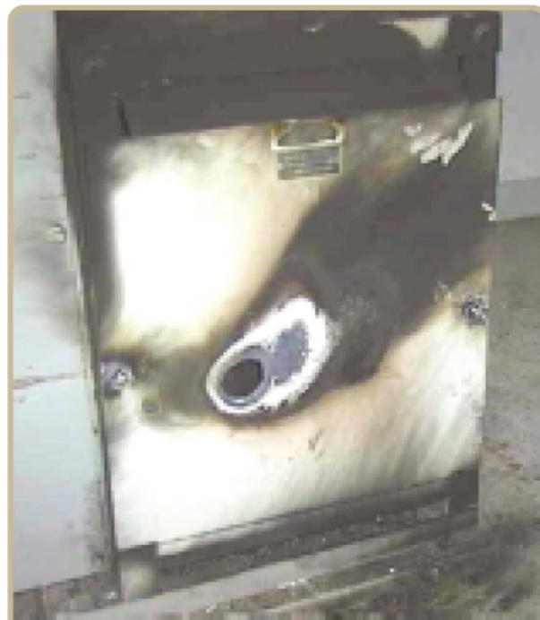
*Figure 5 : résultat d'un amorçage interne sur un équipement fermé.*
