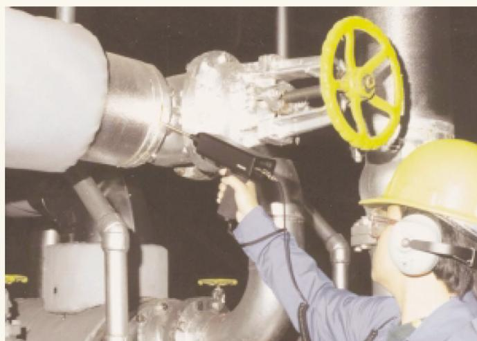
*Figure 4 : les ultrasons permettent de localiser facilement les turbulences générées par la fuite sur le côté aval de la vanne. L'intensité ultrasonore est comparée de chaque côté de la vanne. Pour les fuites très faibles, il est recommandé d'utiliser un appareil doté d'un filtre suiveur permettant d'écouter les signaux ultrasonores émis au alentours de 20 kHz.*
