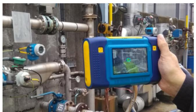
La détection ultrasonore est également l'un des moyens les plus simples et efficaces pour œuvrer à la sobriété énergétique, en identifiant et localisant les fuites des réseaux d'air comprimé ou de gaz, ou des réseaux sous vide.
