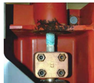
L'activité DP provoque une détérioration progressive des composants qui est la principale cause de panne d'installations.
