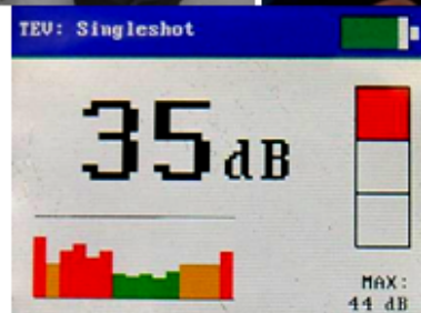
L' UltraTEV Plus+™ mesure les émissions ultrasonores de surface et de TEV internes.
