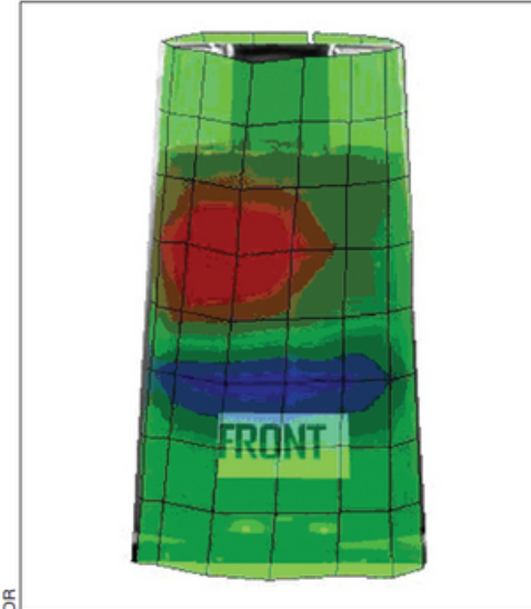
Figure 5 : répartition de l'intensité sur la surface du moulin à café à 379 Hz.
