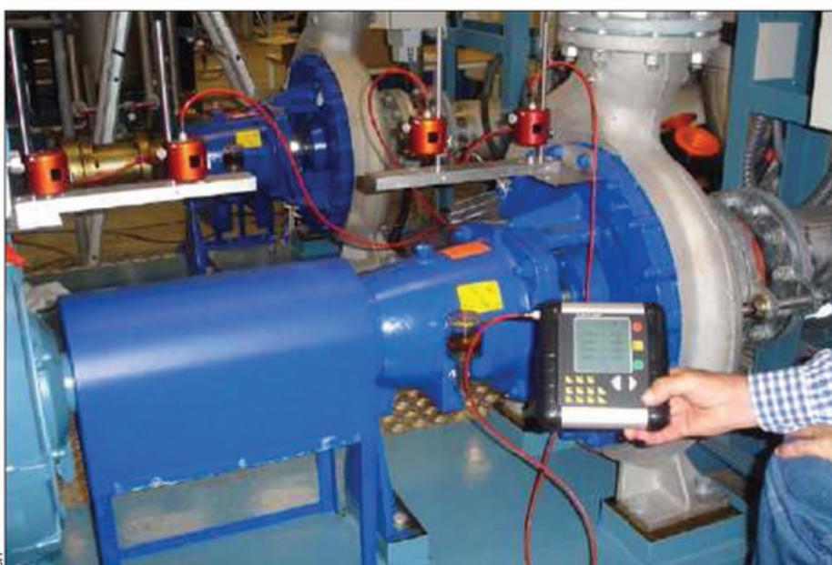
Bien qu'un alignement à chaud nous donne une bonne indication sur la dilatation thermique des éléments d'une machine, il ne nous donne pas une mesure en temps réel de l'alignement des machines en fonctionnement. Pour cela, nous avons utilisé un capteur laser D23 et 4 détecteurs avec tête tournante D6.
