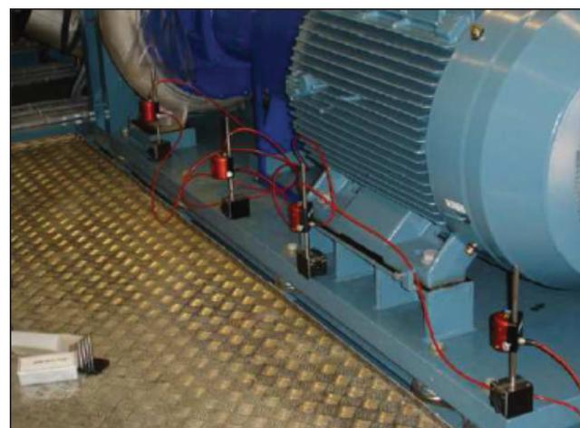
Nous avons ensuite démarré le moteur et fait fonctionner la machine à plein régime à sa température maximum de fonctionnement. Les résultats de mesure ont montré que la partie arrière de la base était montée de 0,5 mm et avait fléchi de 0,2 mm dans le centre, c'est-à-dire au niveau de l'accouplement.
